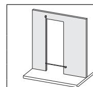
1. Sätt en pappbit eller motsvarande material som skydd under dörren för att hindra att dörren kan stöta sig mot golvet. En härdat glasdörr kan splittras i små bitar av en sådan stöt. **OBS!** Låt stödbrädan i dörrkarmens ned-sida sitta kvar under montering!
